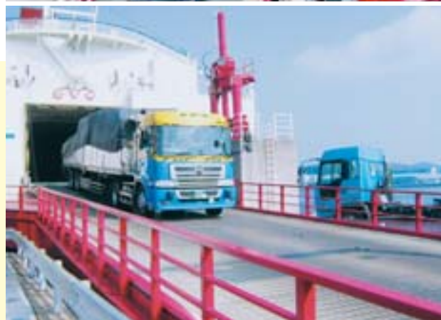
トラクターヘッドで乗り入れ、シャーンをつないで降る作業が繰り返される
