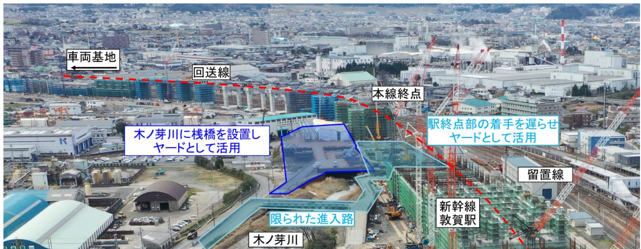
写真-15 大型栈橋による河川上のヤード確保 (水着色：本線上のヤード 青着色：河川上のヤード)
