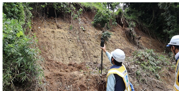
写真－1 三次元測量機器による調査状況
