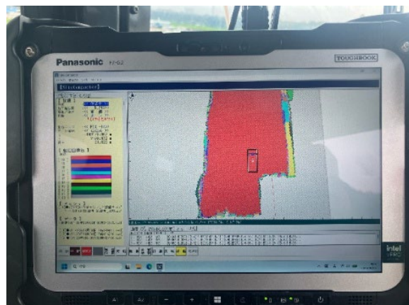
図 2 ICT 活用工事（締固め回数管理）
