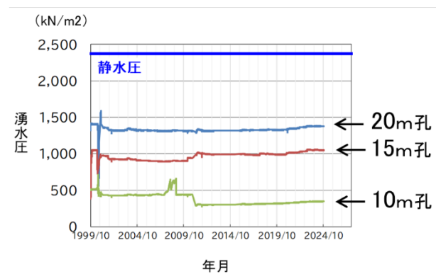
図－7 湧水圧経時変化（作業坑 11km100m）
