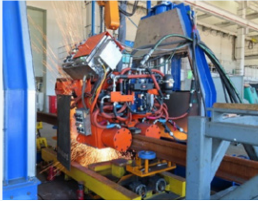
フラッシュバット溶接（左：テスト溶接状況、右：北海道新新幹線の現場溶接状況）
