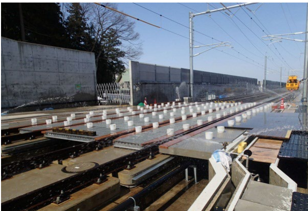
写真-2 散水分布の測定風景
