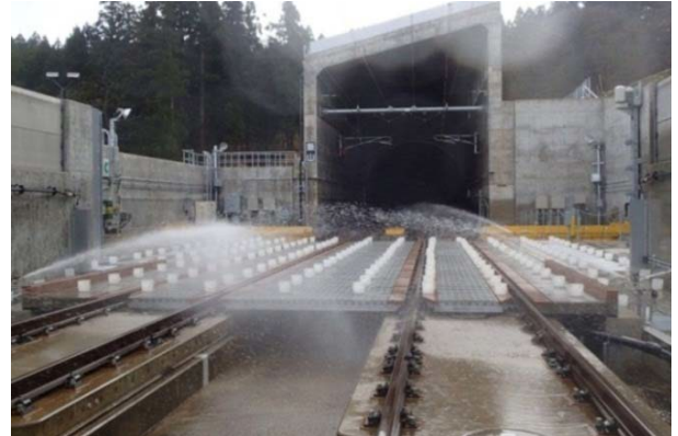
写真-3 散水分布の偏りの解消
