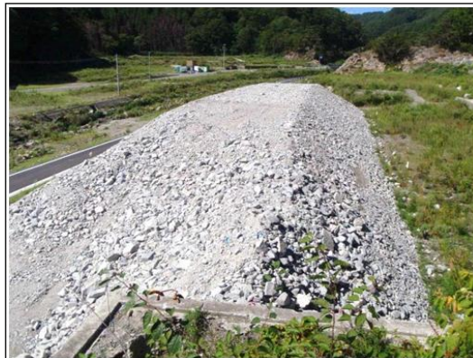
トンネルずり
