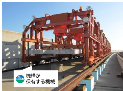
軌道スラブ運搬敷設車
