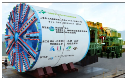
写真-1 羊蹄トンネル（比羅夫）のシールドマシン
