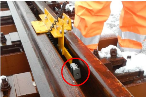
写真-3 推力測定器
