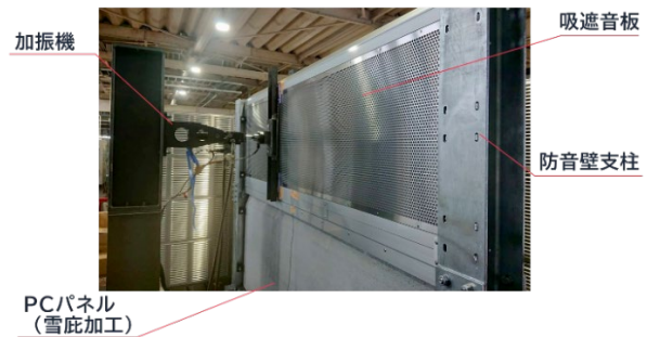
写真-6 繰り返し荷重試験
