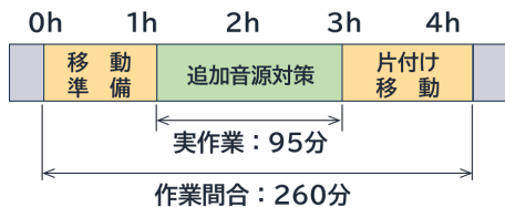
図-3 追加音源対策の作業工程の例
