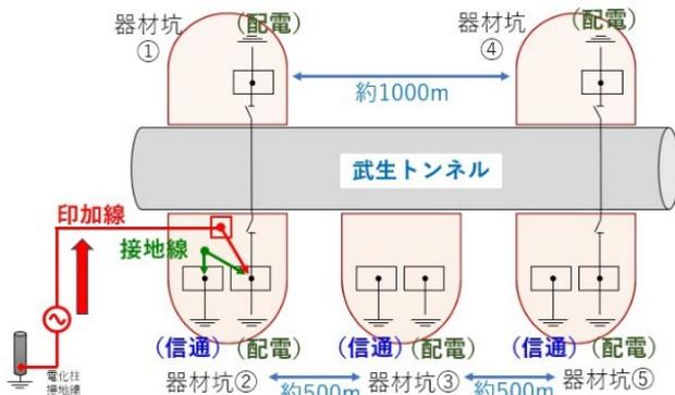
図-9 模擬試験環境(共用接地方式)
