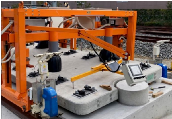
図-10 次世代型スラブ敷設ゲージの試験
