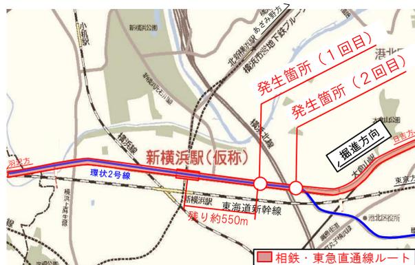
図4-9 新横浜トンネル工事付近における道路陥没の発生位置
