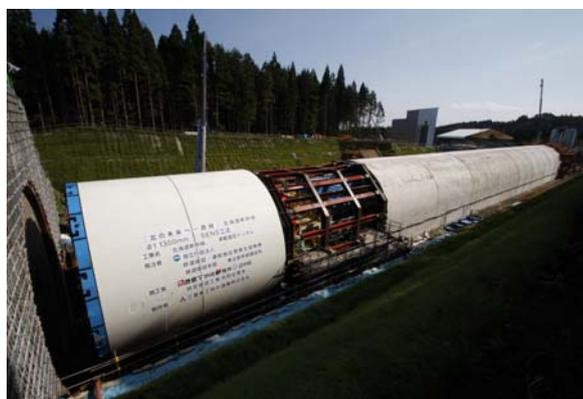
写真-5 掘削開始前の SENS マシン
