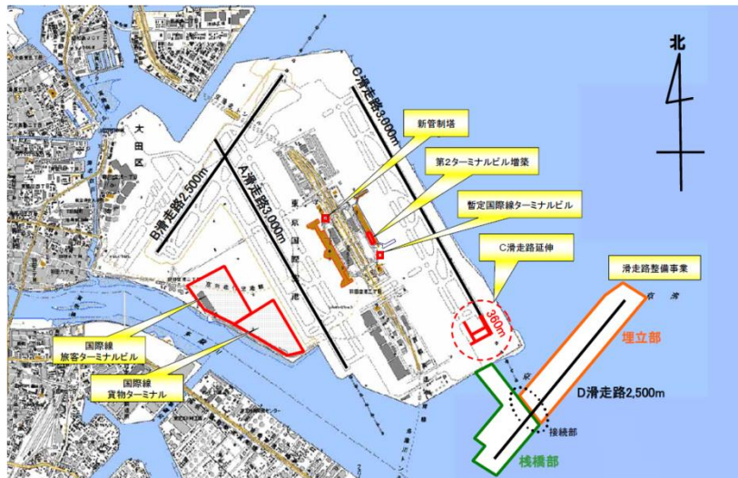
図 2-19 羽田空港再拡張事業・C滑走路延伸の概要
