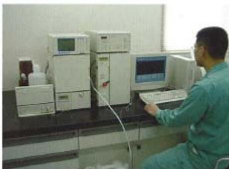
現地の試験室にてトンネル掘削発生土の成分分析、水質検査を行い、分別の判定管理を行っている。
