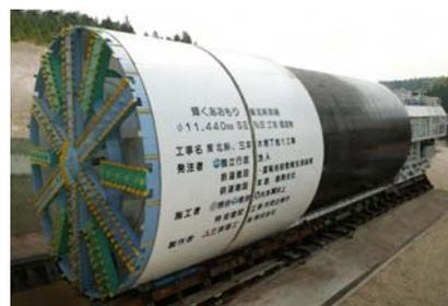
写真-10 シールド掘削機・場所打ち支保システム(SENS)の採用
