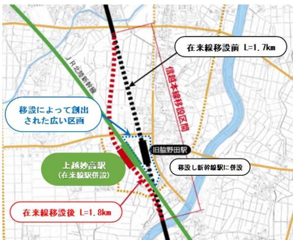
図10 在来線移設の概要図
