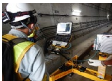
3次元レーザーによる 建築限界測定
