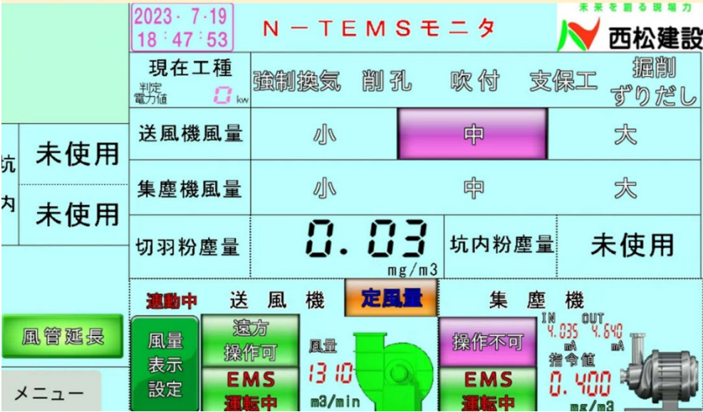
トンネル工事における省エネシステムの 制御画面
