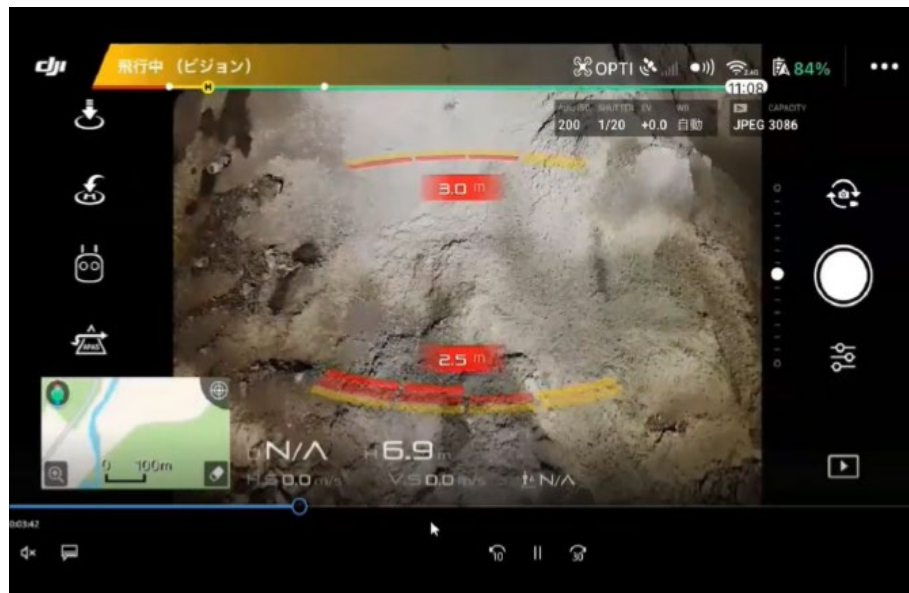
ドローンを活用したトンネル切羽の肌落ち確認
