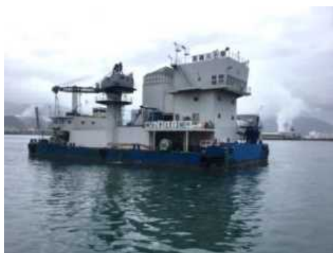
写真 1. 1. 1-4 生コンクリート不足対策として活用したプラント船及び生コンクリートプラントの整備状況
