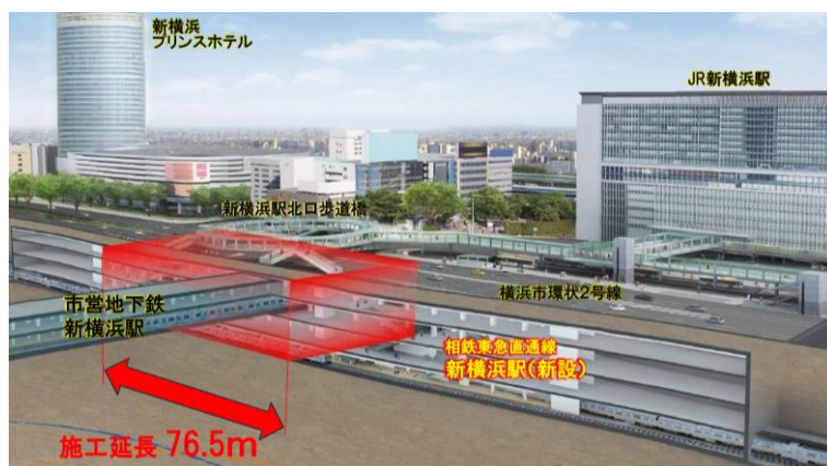
図 1.1.4-3 相鉄・東横直通線 新横浜駅のアンダーピニング施工箇所
