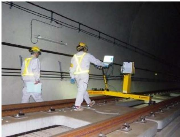
写真 1.1.1-6 3次元レーザーを用いたトンネルアーチ部の建築限界測定
