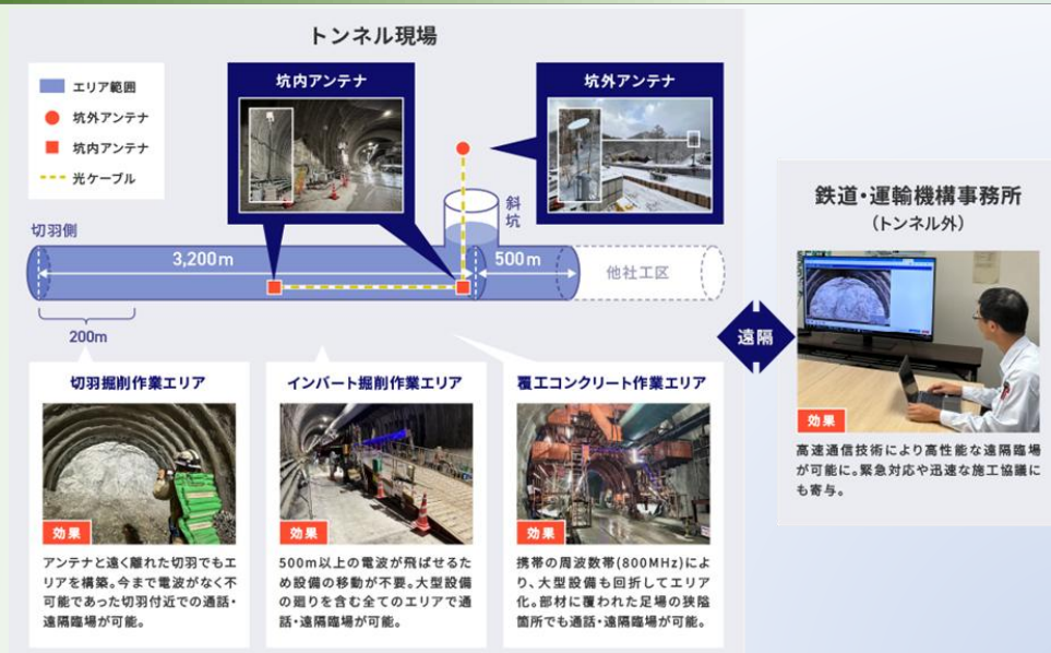
写真3-1-1-1 携帯不感地での遠隔臨場の実施 (北海道新幹線、渡島トンネル(上二股))
