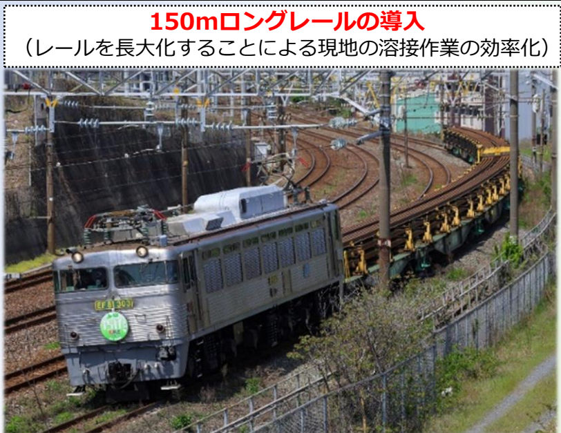
写真3-1-1-6 150mレールの貨物鉄道運搬
