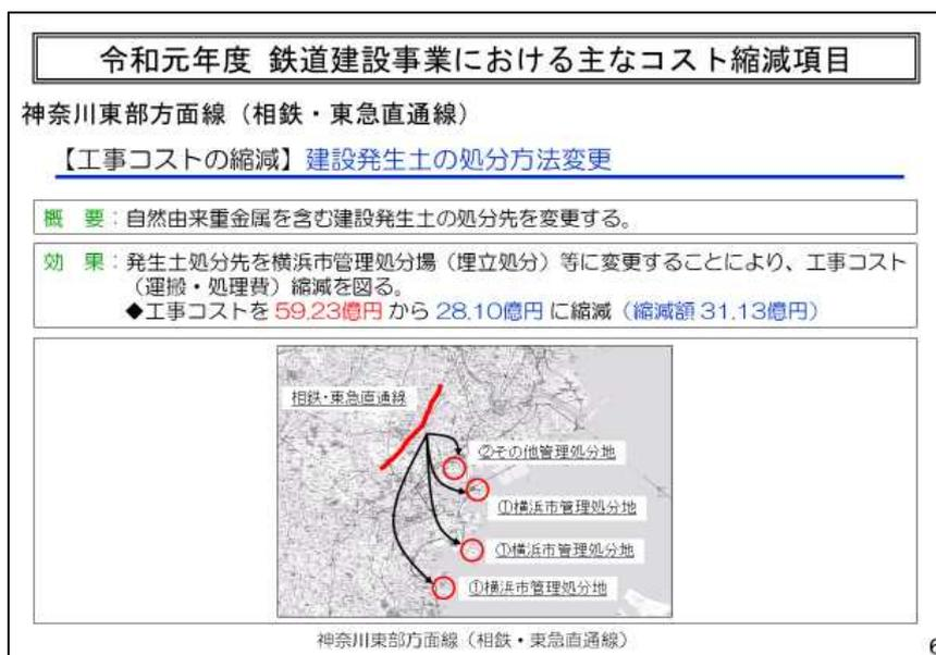
図 1.1.2-2 コスト縮減の取組み例（建設発生土の処分方法の変更によるコスト縮減）
