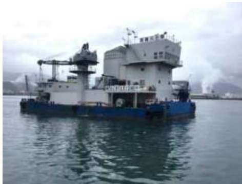
写真 1. 1. 1-4 生コンクリート不足対策として活用したプラント船及び生コンクリートプラントの整備状況
