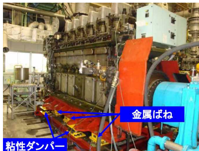
図 1.5.3-7 内航船向け中速主機関用金属ばね防振装置
