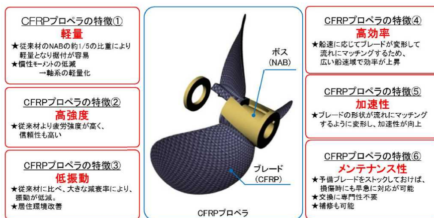
図 1.5.3-6 複合材料製プロペラの概要
