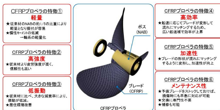
図 1.5.3-6 複合材料製プロペラの概要
