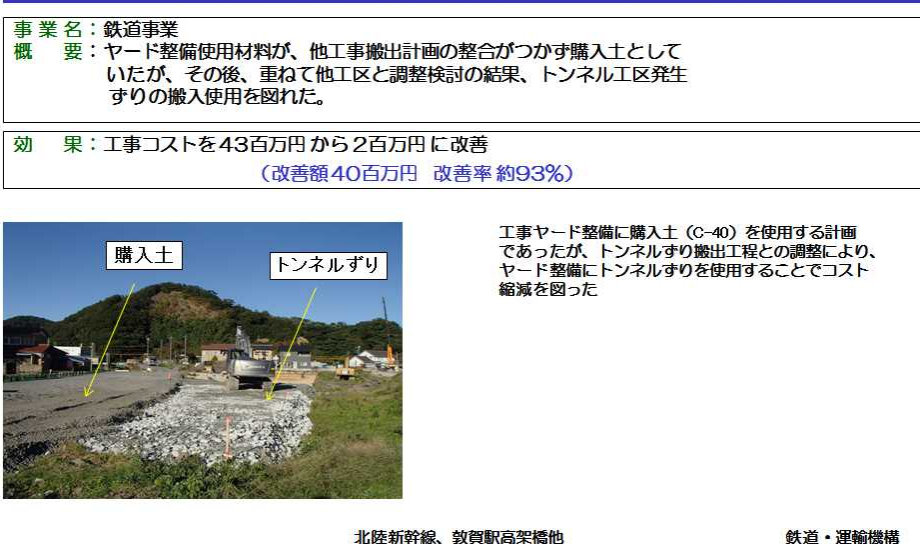
図 1.1.4-6 コスト構造改善策の取組み例② (ヤード整備材料にトンネルずりを使用することによるコスト改善)
