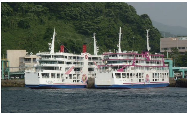
（写真左）「第二桜島丸」（二重反転ポッド型SES旅客フェリー、平成27年3月竣工）
