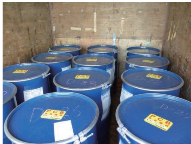
PCB廃棄物ドラム缶保管状況 （東京貨物ターミナル駅）
