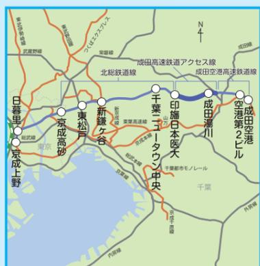
成田スカイアクセス線は、成田空港と都心を結ぶ空港アクセスの路線で、北総鉄道線と成田空港高速鉄道線との間に鉄道新線(最高速度160km/h)を整備しました。平成17年4月に成田高速鉄道アクセス株式会社からJRTTが工事を受託し建設しました。
