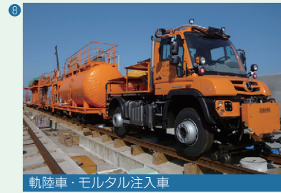
軌道車・モルタル注入車
