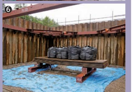
①大型スクリーンで施工状況を説明する薬師寺現場代理人 ②国道を越える部分では深礎工法を採用している ③ニツ森トンネル坑口から見た明治高架橋施工現場全景 ④鉄筋が打ち込まれた初期の段階のRC橋脚 ⑤RC橋脚の足場 ⑥平板載荷試験の様子
