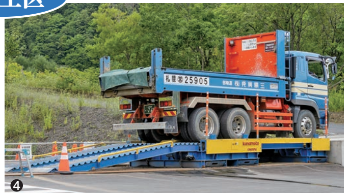
① AGF工法の施工状況 ②濁水処理施設 ③トンネル空間を保持する鋼製支保工 ④ダンプカーの車輪洗浄機
