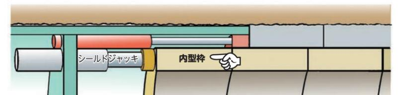
③掘進終了。シールドジャッキを縮め、新たな内型枠を組み立てる。①に戻る。
