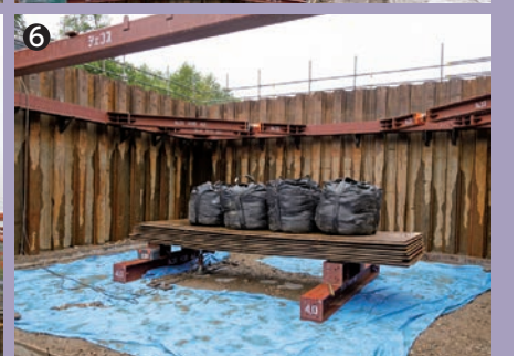
①大型スクリーンで施工状況を説明する薬師寺現場代理人 ②国道を越える部分では深礎工法を採用している ③ニッ森トンネル坑口から見た明治高架橋施工現場全景 ④鉄筋が打ち込まれた初期の段階のRC橋脚 ⑤RC橋脚の足場 ⑥平板載荷試験の様子
