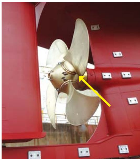
可変ピッチプロペラの例。プロペラ翼の角度が変えられるようになっている付け根の部分に注目
