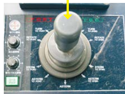
ベクトル舵装備船の出入港用操縦装置。ベクトル舵は、主プロペラの推力の大きさと方向を、このジョイスティック 1 本で 360° 制御できる
