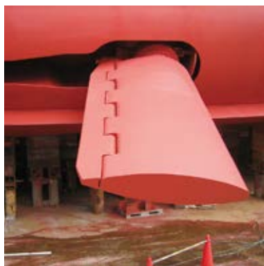
⑧ フィンスタビライザ 写真右が船首方向。このような大型のものは、入港時に岸壁に当たるので格納できようになっている
