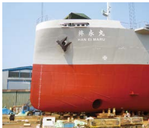
絆永丸（セメント専用船）の垂直型船首。タイタニック号の時代の船と形は似ているが船型的には全く異なる
