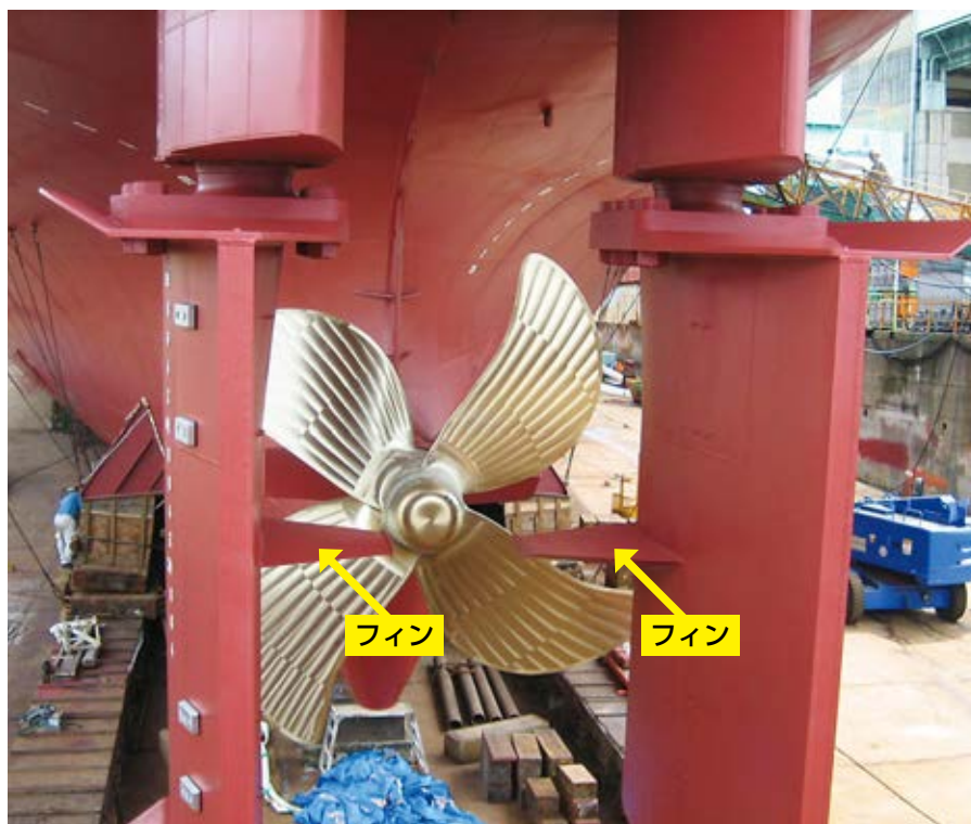
ベクトル舵。舵の内側に省エネ目的のフィンが付いたタイプ。 舵の外側に防食陽極が見える
