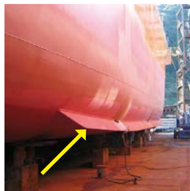
⑨ ビルジキール
