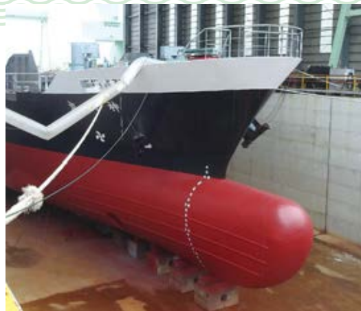
バルバスバウの例。造船所によってもバルブの形はさまざま
