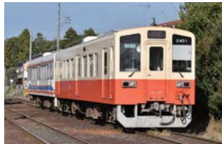
キハ2400形。平成16・17・19年に新造された車両で、キハ2200形をベースに、電気指令式ブレーキや、保安ブレーキの二重化、駅名案内装置を設置した両運転台の車両
