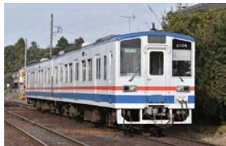
キハ2100形。平成5年から平成8年にかけて新造車両として導入された。機関、変速機、台車などに新型機器を採用し、省エネ・高性能化に努めた
