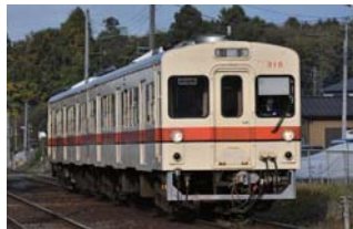
キハ310形。旧国鉄のキハ10・20系気動車から機関、変速機、台車などを流用した車両で、昭和51～52年にかけて導入された
