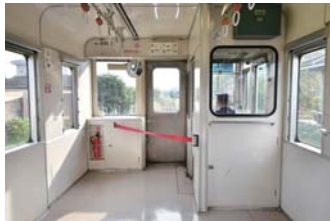
竜ヶ崎方の運転台を右側に配置した、珍しい車両構造
