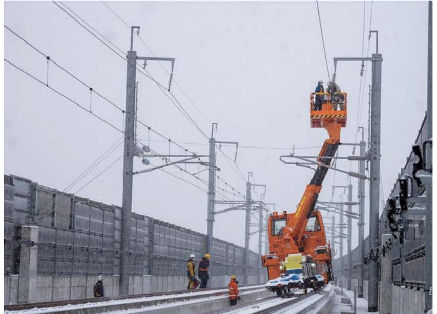
軌道モーターカーに高所作業装置を取り付けた架線作業車。作業台の高さと広さが異なる車両が使い分けられている
