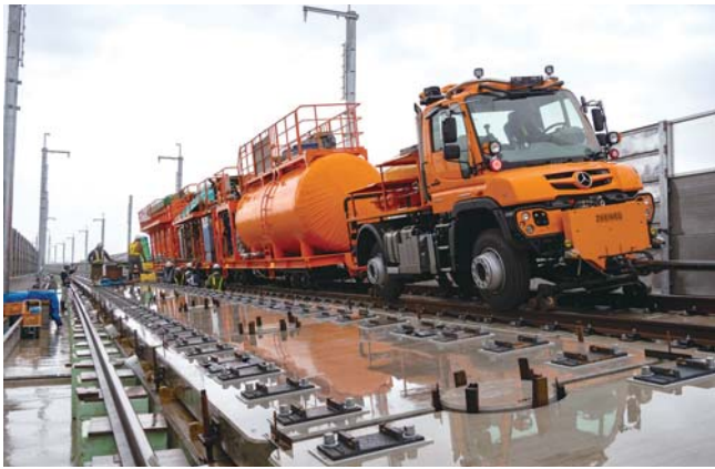
最新式のCAモルタル注入車。3両編成で、動力車の次位が水とアスファルト乳剤のタンク、最後尾がセメントと砂のタンクで、中央の車両でミキシングする
