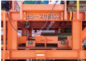
レール送込み装置車に引き込まれたレール。下のローラーが回って前方に送り出される
