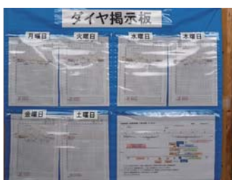
仮軌道が敷設された区間については、各種作業車両の通行ダイヤが日ごとに定められ作業の円滑化が図られている
