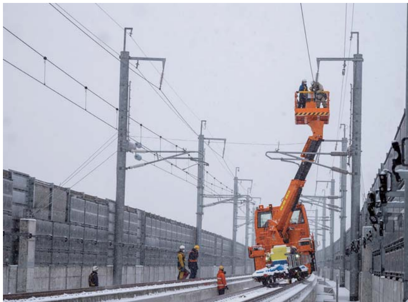
軌道モーターカーに高所作業装置を取り付けた架線作業車。作業台の高さと広さが異なる車両が使い分けられている
