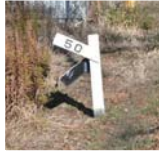
地上に出るとすぐに急勾配が続く(上)、50 パーミルの上り勾配を示す標識(左)
