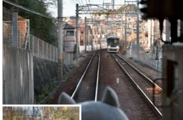
地上に出るとすぐに急勾配が続く(上)、50 パーミルの上り勾配を示す標識(左)
