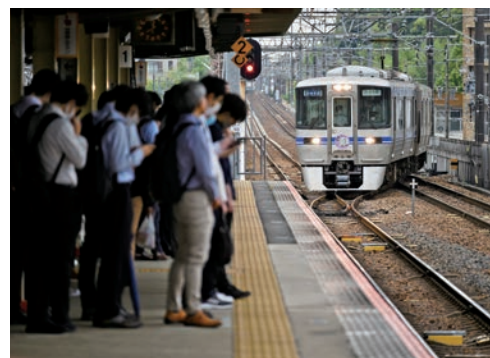
朝のラッシュ時に新豊田駅に入線する「あさシャトル」。三河豊田駅までを複線化し、大都市通勤鉄道並みの高頻度運転を実現している
