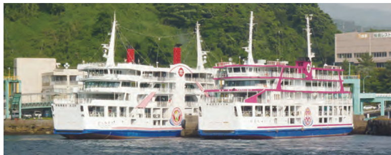
(写真左)「第二桜島丸」(二重反転ポッド型 SES旅客フェリー、平成27年3月竣工)
