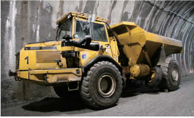
掘削したずりを坑外に出す約 25tの重ダンプ。本坑掘削が進むと連続ベルトコンベアに切り替わる
