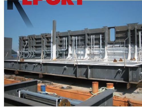
パイプや電路が先行艤装された船側部分のブロック
