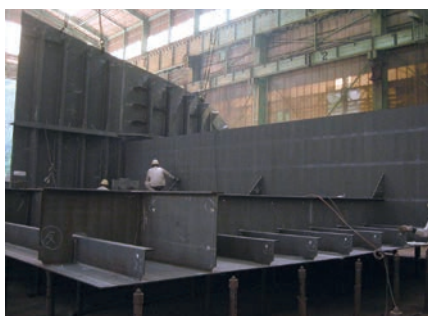
中組みされた大物部品でブロックを組み立てる。大組段階でやっとブロックの形が見えてくる
