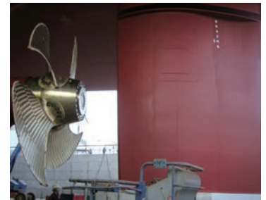
本船のプロペラは直径 5.8 m あり、翼のひねりを変えて推進力を制御する可変ピッチプロペラである
