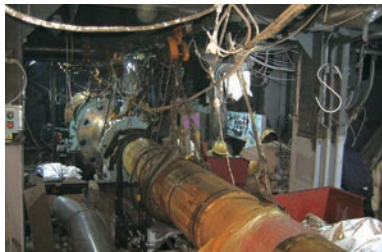
推進軸付近。狭い箇所の艀装作業中は、このように足の踏み場のない状況になる
