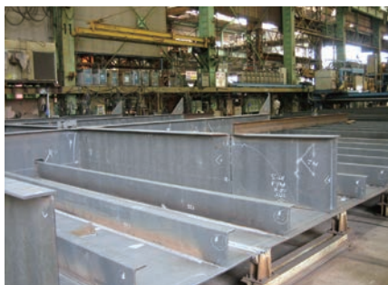
中組作業中の車両甲板ブロックの一部。小組みされた部品を集めて大きな部品を作っていく
