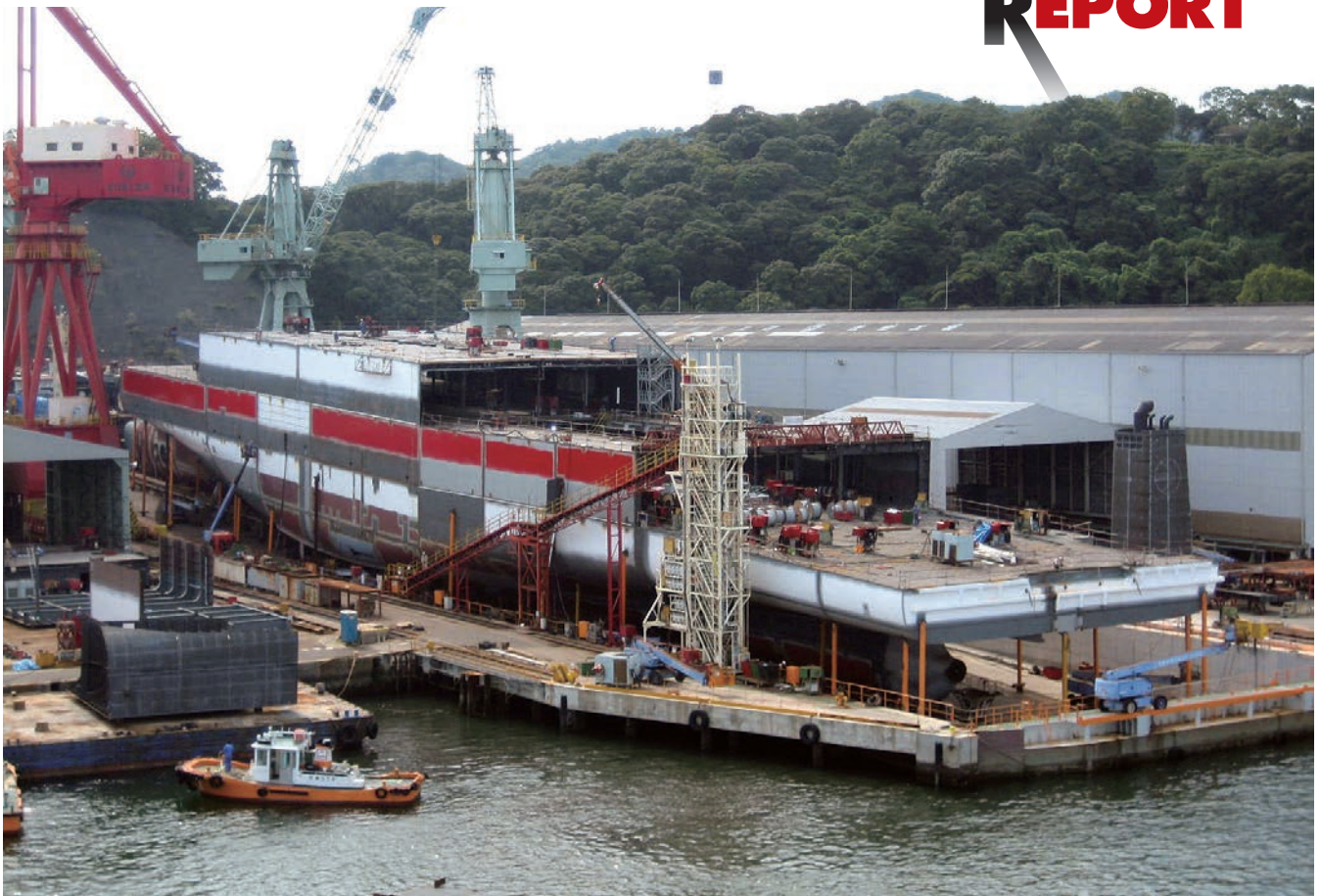
佐伯重工業の船台で建造中の「フェリーしまんと」。ブロックの継ぎ目がよくわかる
