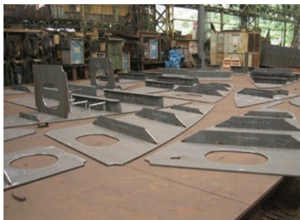
切断された部材を組み立てて構造部品を作る小組作業
