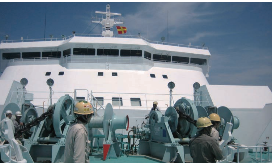
海上試運転で、錨の上げ下げを確認する投揚錨試験
