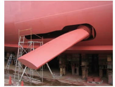
横揺れを軽減するフィンスタビライザ。水中に出した翼の角度を制御して揚力で横揺れを抑える
