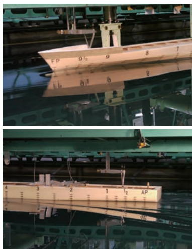
水槽試験の様。模型船を曳引して船体抵抗を測る。写真（上）は船首部分、写真（下）は船尾部分
