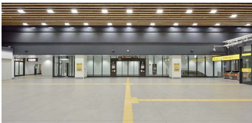
写真6 警告誘導ブロック（北海道新幹線、新函館北斗駅）
