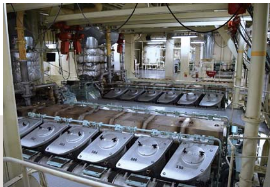
機関室。足下の主機関、12PC2-6Bは2基合わせて14,000kWを生み出すハイパワーエンジンだ
