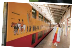
天井の高い2階建車両。京阪電鉄から譲渡された際、車両限界を修正した
