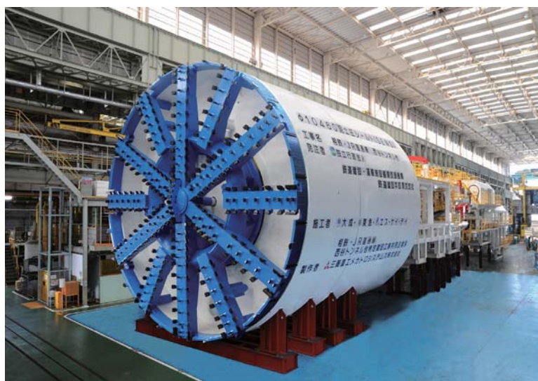
シールドマシン (仮組立状況)
