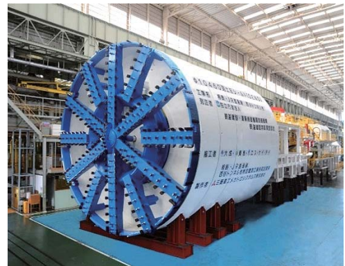
西谷トンネル工事で使用したシールドマシン
