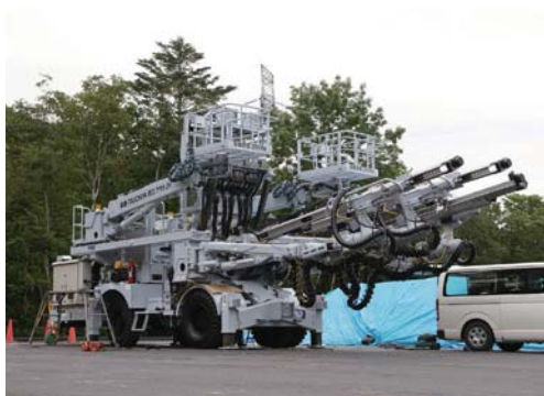
東川工区の本坑掘削開始を待つドリルジャンボ。このアームが開けた孔に火薬を装填し、爆発させる発破工法を行う予定だ
