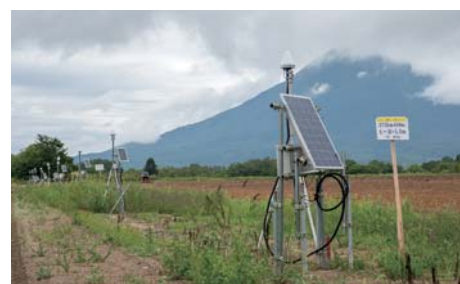
ニセコトンネルのほぼ直上では、24時間体制でGPSによる変位監視が行われている
